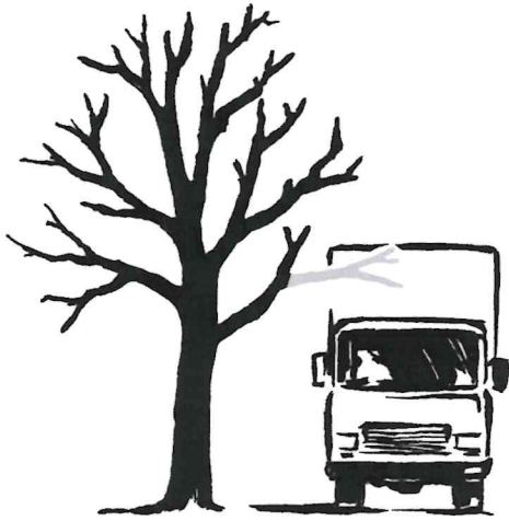
Korrektter Lichtraumprofilschnitt bei Ästen über 10 cm Durchmesser (Schnitt auf Versorgungsast)
