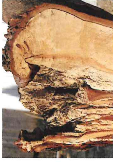
Oben: Pilze dringen in die Kappstelle ein und zerstören das Holz
