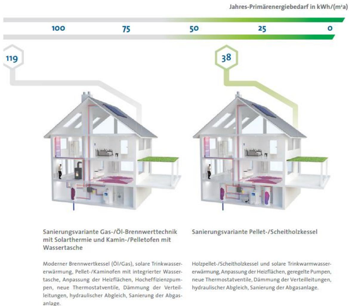
**Abbildung 25 Einsparpotenziale durch Kombination effizienter Anlagentechnik und energetischer Sanierung der Gebäudehülle**
