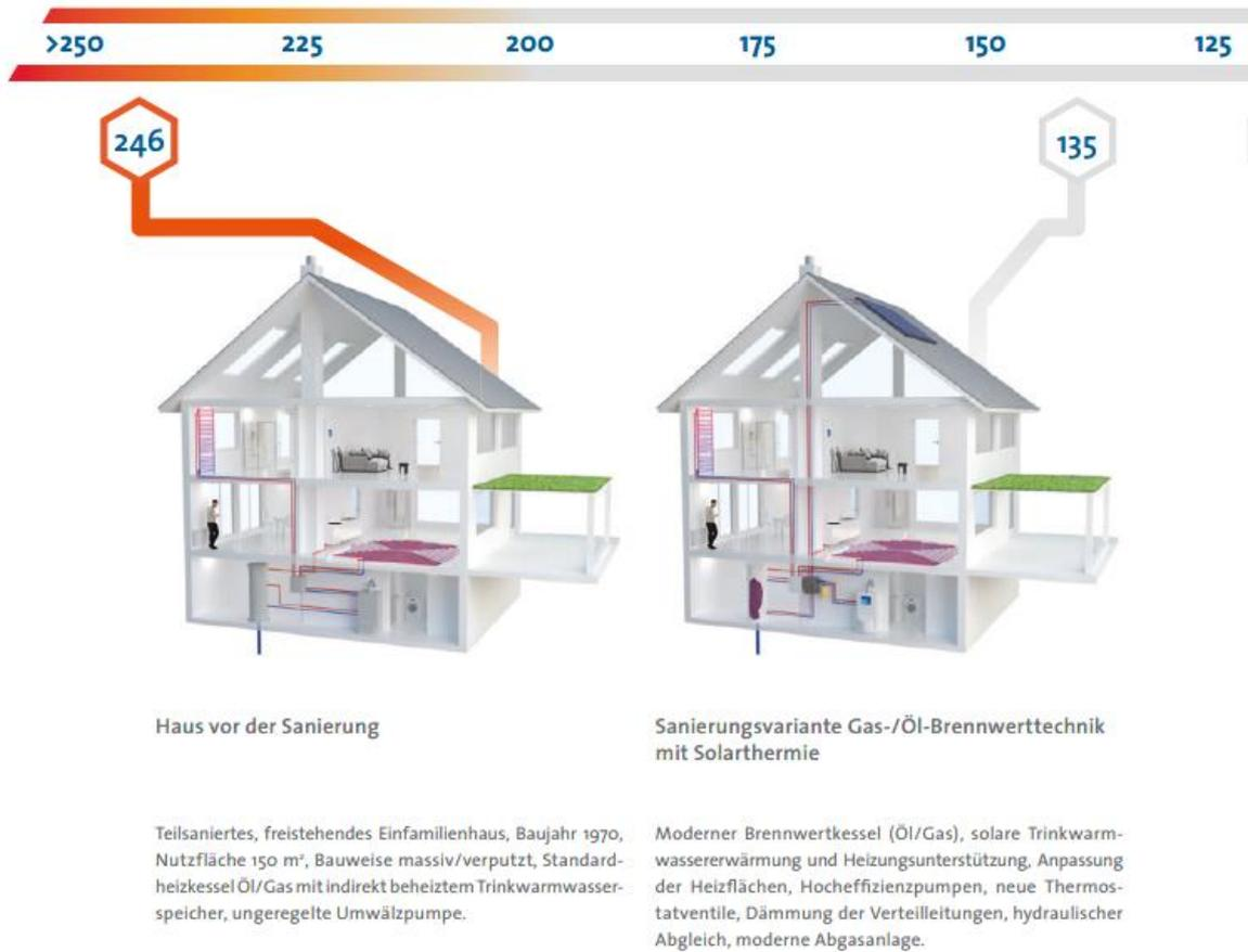
**Abbildung 24 Einsparpotenziale durch Nutzung effizienter Heiztechnik**
