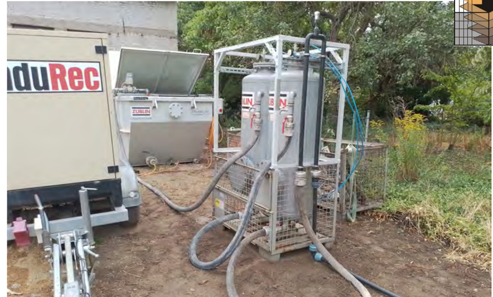
Vorhaltebecken (Hintergrund) und zwei hintereinandergeschaltetem Aktivkohlefilter für die Grundwasserabreinigung.
