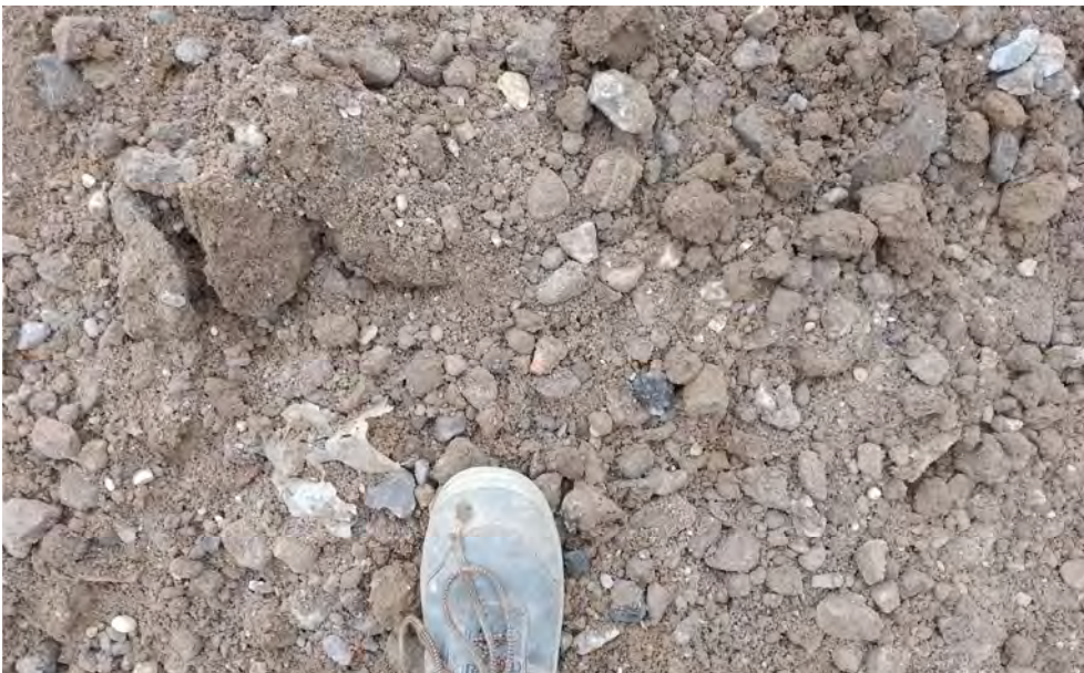
Detailansicht der PAK-haltigen Auffüllungen. Rolliger Boden mit Anteilen an Schwarzdecken, Schlacken und Bauschutt
